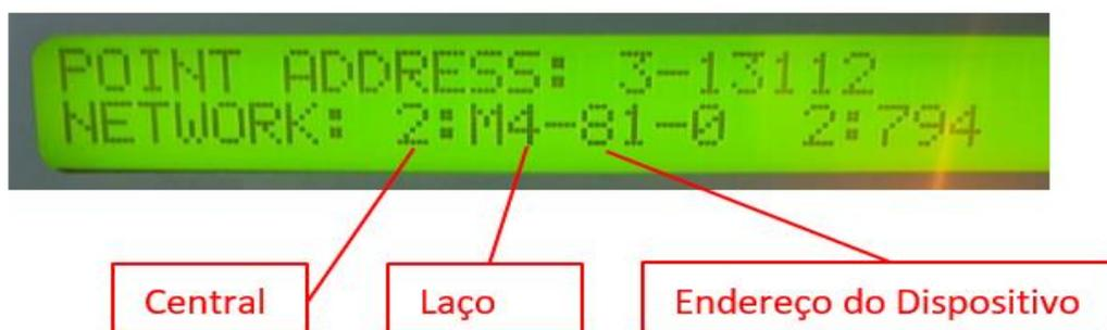
Figura 12. Point Address – Endereçamento do Dispositivo em Alarme
